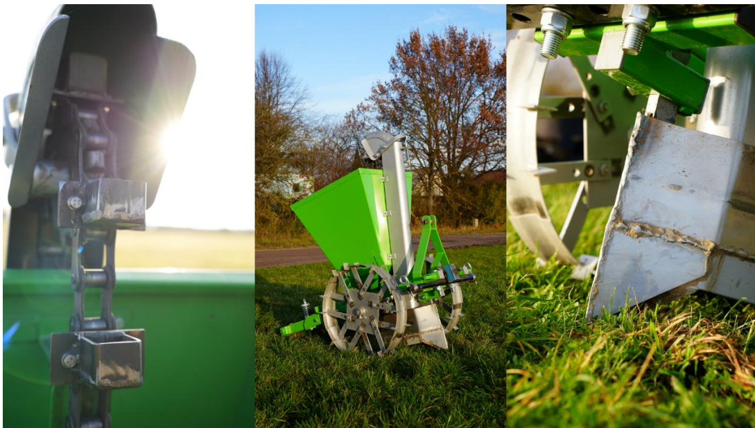
Abbildung 21: "Agroforst-Drille", ein umgebauter Kartoffellegger zur Aussaat von Saatgut diverser Gehölze und krautiger Pflanzen (Mitte). Nahaufnahme der angefertigten Schaufeln zur Förderung des Saatguts (Links); modifizierte Schar, um das Saatgut in den Mineralboden einzubringen (Rechts). (Abb.: Finck Stiftung 2024)
