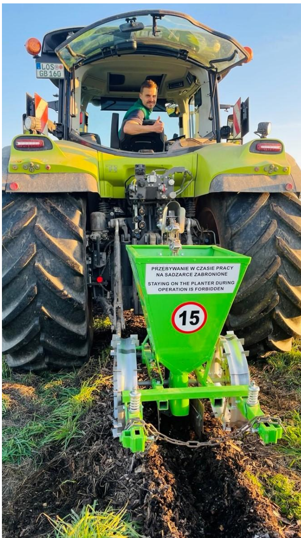
Abbildung 10: Saatgut von Gehölzen und krautigen Pflanzen wird mittels einer modifizierter Kartoffellegemaschine ausgebracht. (Abb.: Finck Stiftung 2024)
