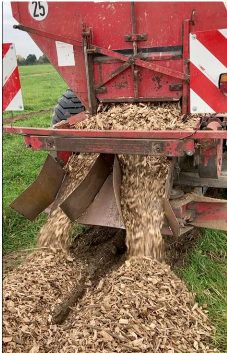
Abbildung 23: Umgebauter Kalkstreuer zur Ausbringung von Holzhackschnitzeln als Mulch im Agroforstsystem. (Abb.: P. Hansen 2024)
